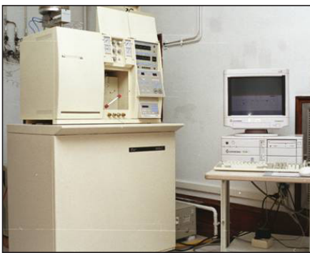
Figura 3. Espectrómetro de masas isotópico Finnigan MAT Delta-C con analizador elemental automático CN integrado.
