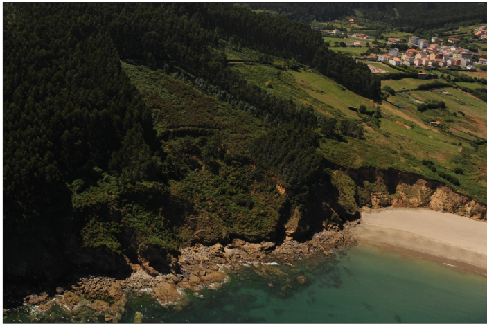
Figura 11. No centro, desprazamento rotacional antigo; á dereita, erosión basal. Cariño (A Coruña).
