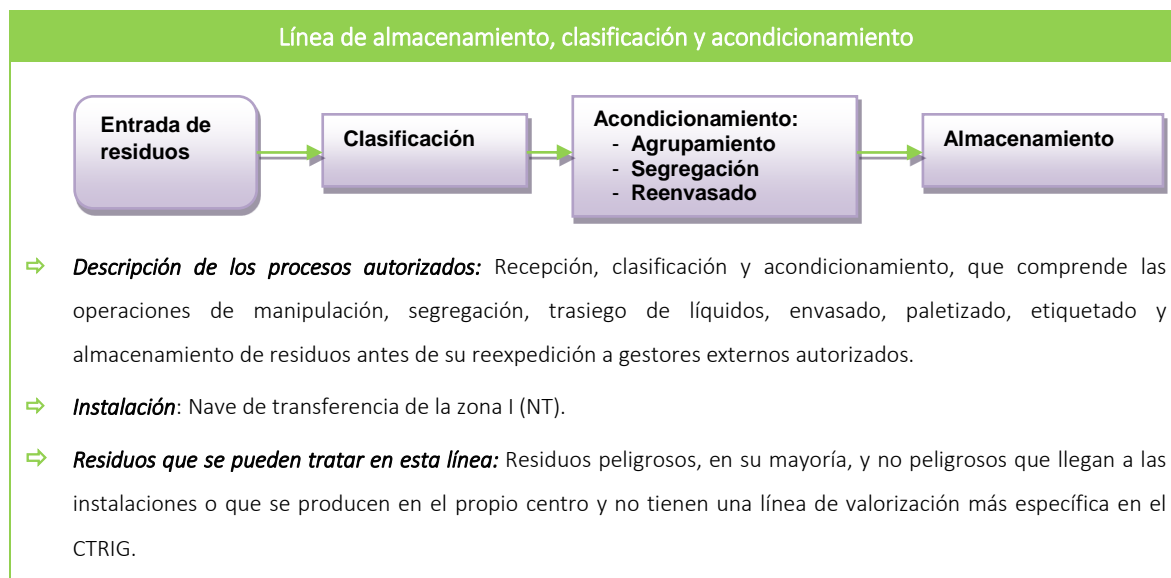
Cuadro 1.- Características básicas de la línea de almacenamiento, clasificación y acondicionamiento
